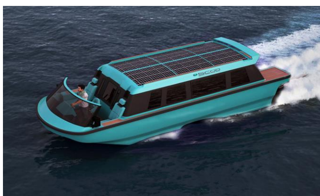
Figura 6 - SWATH Electra Glide, barco elétrico e com painéis solares (T V, 2015).
